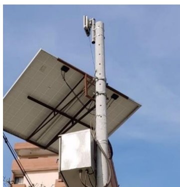
Ilustración 20 Access point principal y secundario
